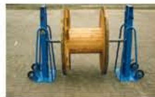
Podnośniki hydrauliczne do bębnow kablowych, o nośnościach 4, 7, 10, 20 ton.
