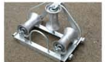
Rolka kablowa narożna, kątowna, waga 13 kg, łożyska kulowe zamknięte, rolka aluminiowa, korpus stalowy, galwanizowana, łożyskownalna, łożyska kablowe 170 mm, do rur i kabli o średnicy max. 150 mm.
