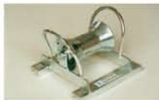
Rolka do układania kabli i rur, łożyska kulowe zamknięte, stalowa galwanizowana, dla rur o średnicy do 300 mm, nośność 200 kg.
