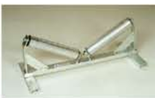
Rolka do układania rur, łożyska kulowe zamknięte, stalowa galwanizowana, dla rur o średnicy 100 – 760 mm, nośność 400 kg.
