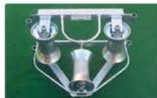
Rolka kablowa narożna, kątowna, waga 15 kg, łożyska kulowe zamknięte, rolka stalowa, korpus stalowy, galwanizowana, łożyskownalna, łożyska kablowe 170 mm, do rur i kabli o średnicy max. 150 mm.
